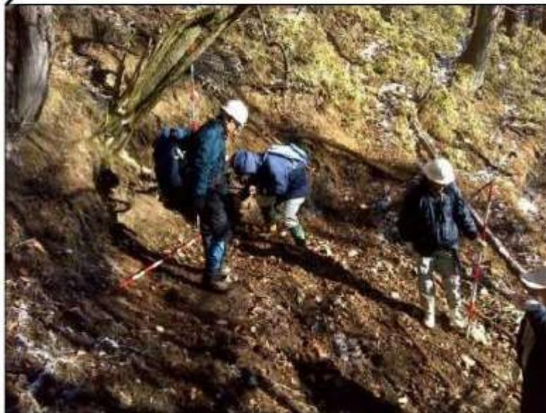
この現場では、現地調査時に湧水が確認できたが、季節や事前の雨量の状況によっては湧水が見られないこともある。路網開設時に湧水がなくても、豪雨時に出水があるので注意が必要。特に、このような場所に盛土すると、崩壊して土石流化する危険性がある。
