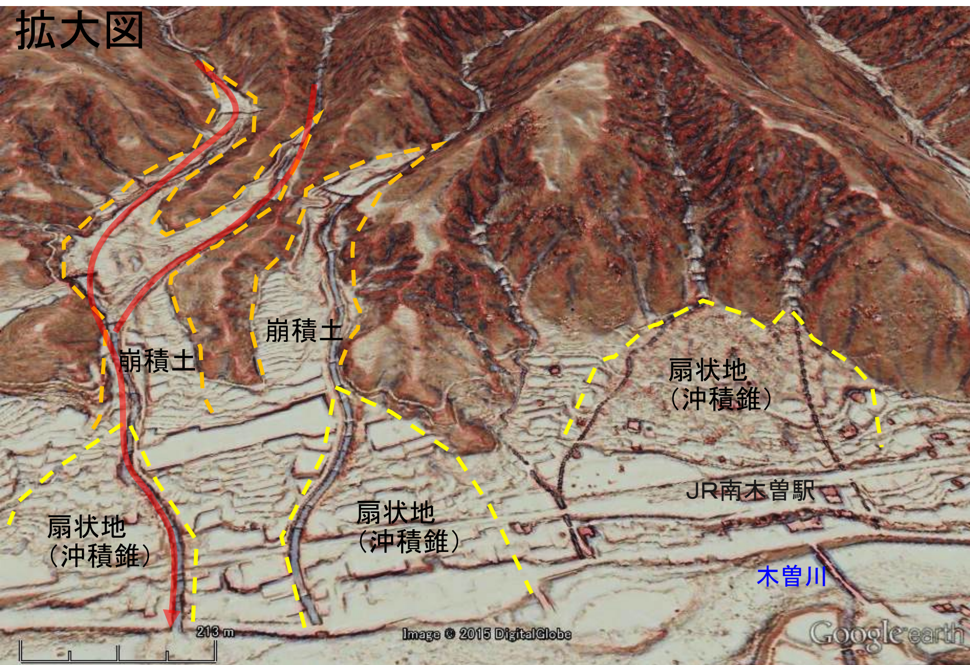
周辺の溪流の出口にも、過去から繰り返し発生した土石流の土砂が堆積している
