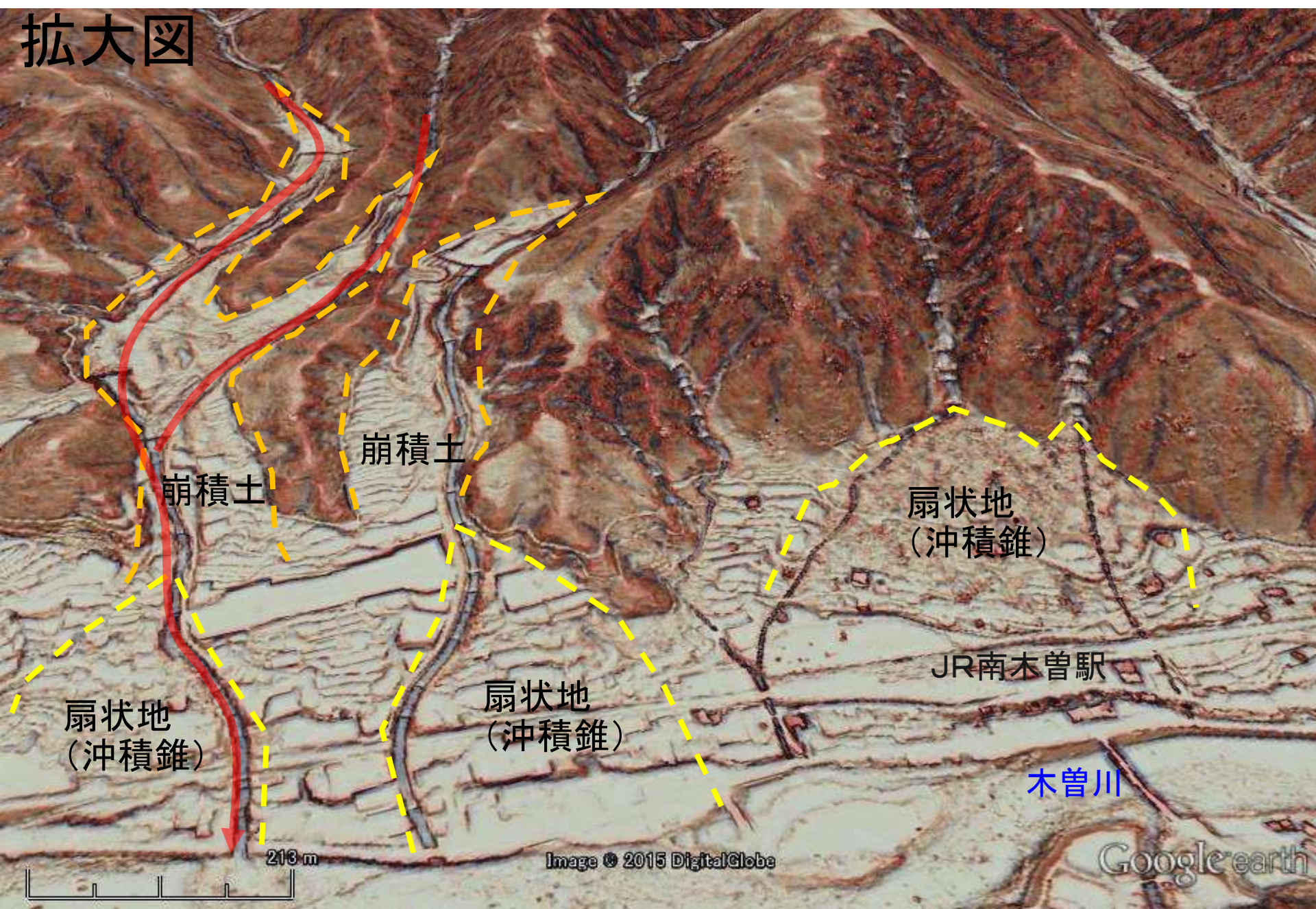
周辺の溪流の出口にも、過去から繰り返し発生した土石流の土砂が堆積している
