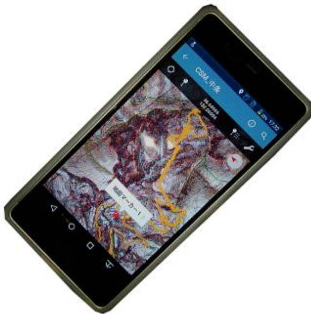
地図アプリによる CS 立体図の表示
